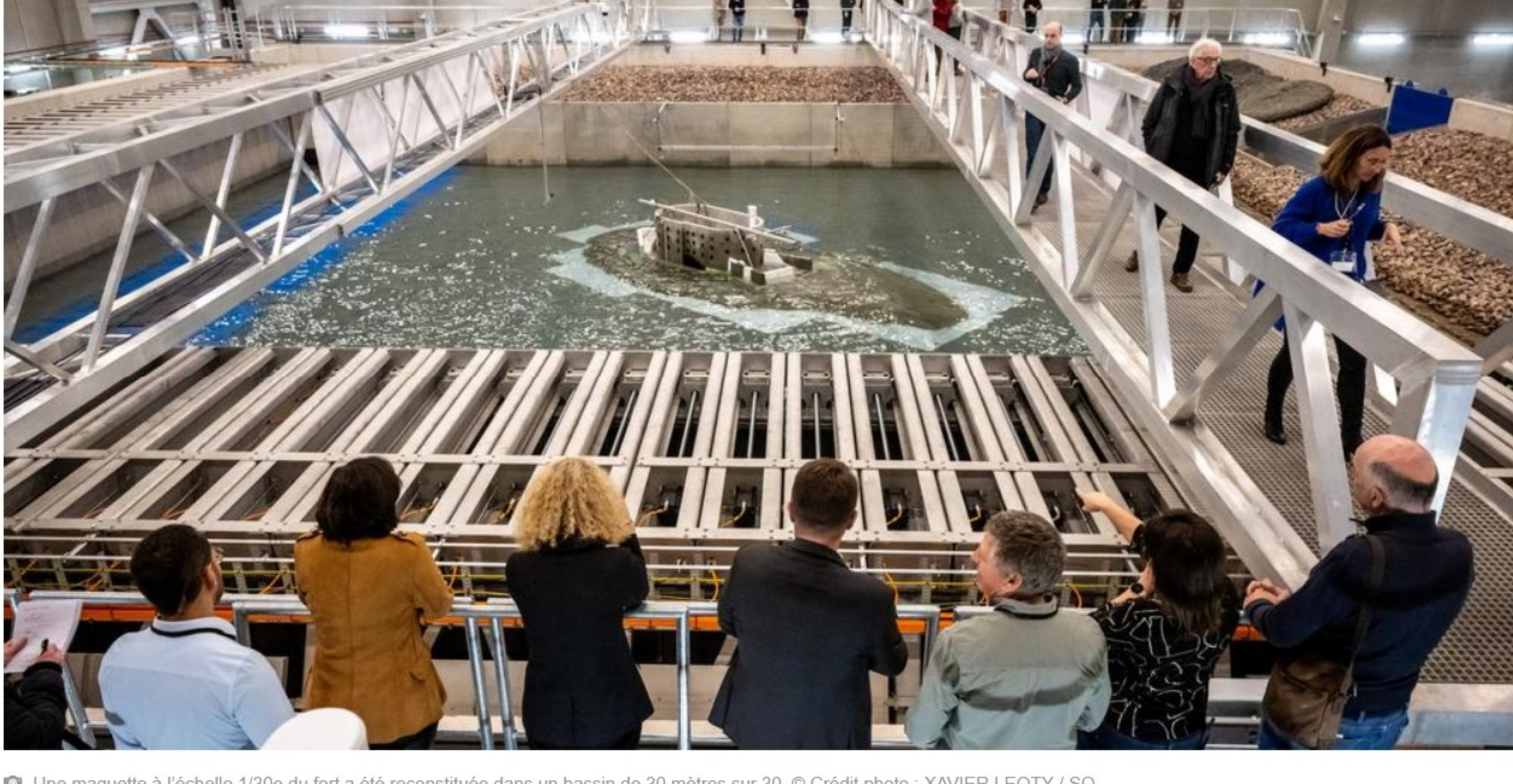
Une maquette à l'échelle 1/30e du fort a été reconstituée dans un bassin de 30 mètres sur 30. © Crédit photo : XAVIER LEOTY / SO
